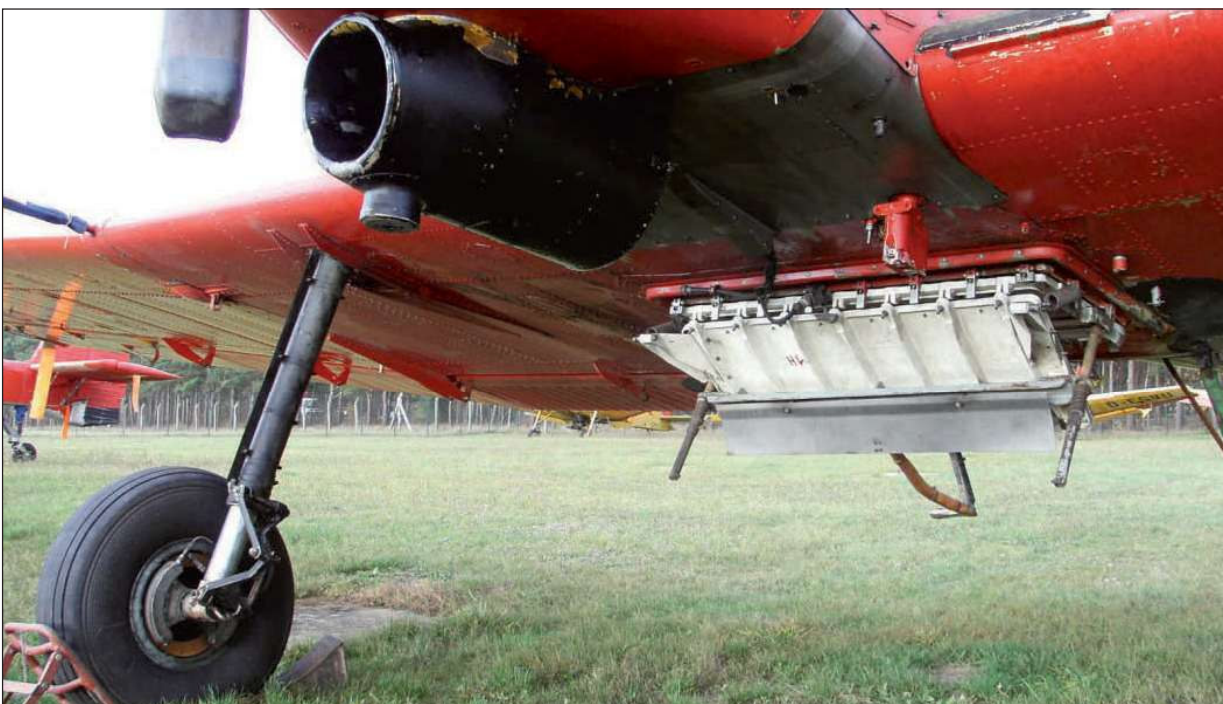
Unter dem Rumpf befindet sich die Auslassöffnung für den darüber liegenden Flüssigkeits-Tank vor dem Cockpit.
