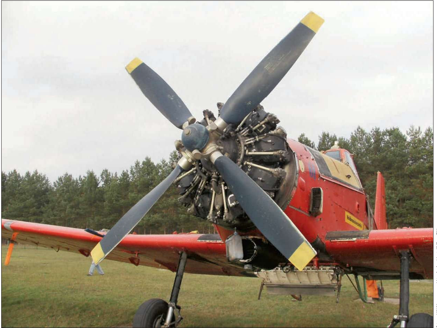
Der freiliegende Sternmotor mit dem großen Vierblatt-Propeller prägt das „Gesicht“ der Dromader.
