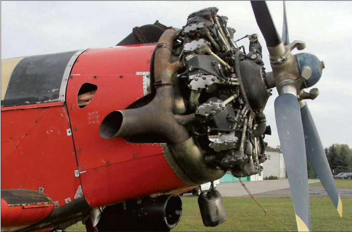
Der Motor von der Steuerbordseite her gesehen mit dem Auspuff am Abgas-sammelrohr.
